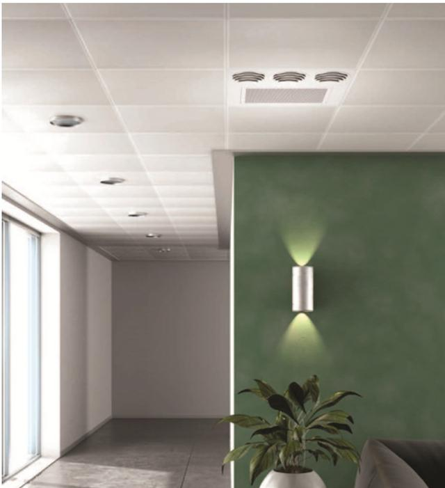
Las unidades Carisma Coanda, gracias a una sección aeráulica particular, permiten generar un flujo de aire de efecto COANDA. La unidad es del tipo monobloc, adecuada para ser instalada dentro de un falso techo. La toma del aire sale desde abajo y el alcance del aire se realiza en paralelo con el techo, por medio de una rejilla práctica y funcional de toma y caudal del aire. El efecto COANDA crea una circulación óptima dentro del ambiente que debe climatizarse.
