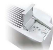
La temperatura ambiente puede ser gestionada con termostatos montados en la unidad, con diferentes soluciones según las necesidades del ambiente. El mando CB-T-ECM permite el control de la velocidad, ajusta con precisión la temperatura y es idóneo para ajustar la velocidad de funcionamiento del ventilador. El CB-T-ECM permite tanto un cambio manual como un cambio automático de la velocidad del ventilador.
