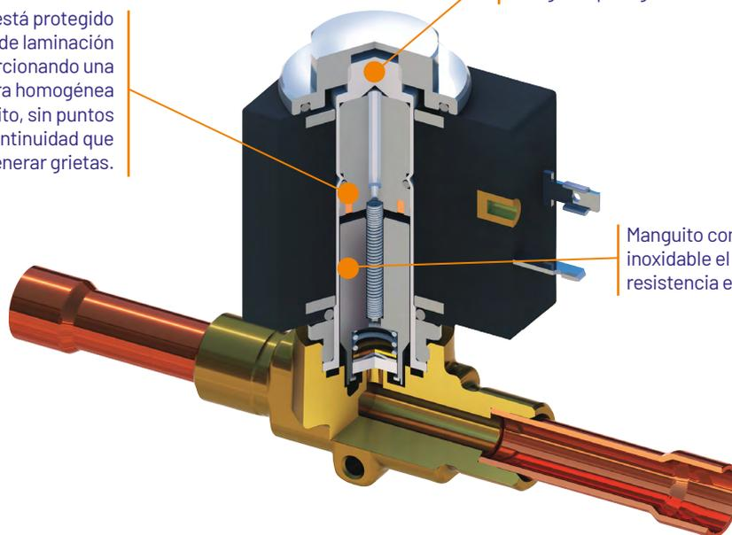
La parte superior que fija la bobina al cuerpo de la válvula, está atornillada en una rosca en la parte superior del manguito, para garantizar una correcta fijación.
