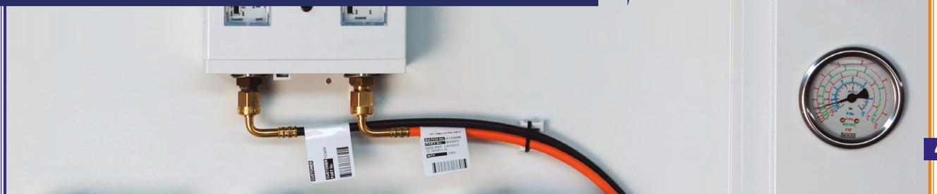
**TUBO TERMO-PLÁSTICO Y RÁCORES PARA TUBO DE 2MM (DN2)**
