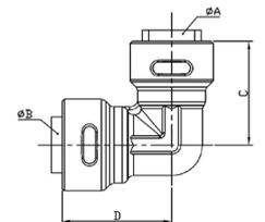
ACCESORIOS PARA UNIÓN TUBO-UNIDAD CONDENSADORA
