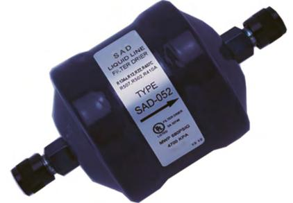
La presentación del tamiz molecular es en forma de bolas, que mediante un fuerte muelle se mantienen totalmente compactas; de esta forma, la ausencia del aglomerante utilizado en los filtros compactos permite una mayor capacidad de retención de humedad.
