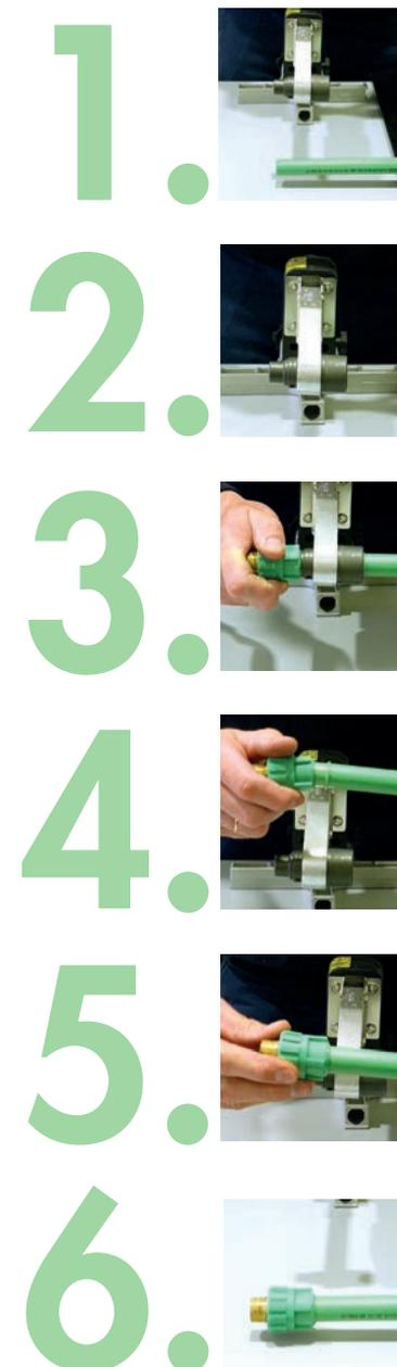
1. Cortar el tubo perpendicularmente a su longitud, utilizando para ello una herramienta que garantice un corte limpio y preciso.
