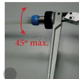
Presionar lentamente las palancas hasta juntarlas y esperar unos 3 segundos. Abrir las palancas, llevar la herramienta unos milímetros hacia atrás, girar la herramienta con un máximo de 45° y volver a introducir los segmentos del cabezal expansor en la tubería. Repetir hasta que el cabezal expansor esté completamente dentro de la tubería.
