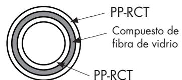
La capa intermedia con el compuesto de fibra de vidrio está fusionada con el material de PP-RCT de la pared del tubo.
