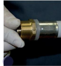
Debe introducirse el accesorio en el tubo hasta su base de manera que el casquillo de acero inoxidable quede unido a la junta plástica anti-electrólisis.
