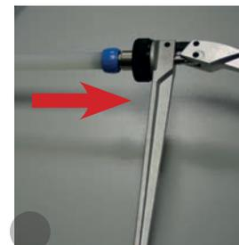
Abrir las palancas del expansor en su totalidad e introducir el cabezal todo lo posible en la tubería.
