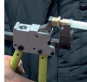
Presionar la palanca de la prensa hasta que la base del casquillo quede unida al accesorio.
