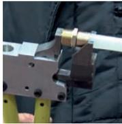
Colocar el tubo y el accesorio entre las cunas de la prensa.
