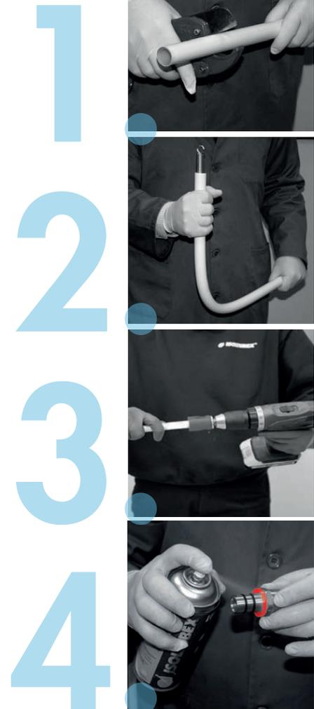
**1** Cortar el tubo perpendicularmente a su longitud, utilizando para ello una herramienta que garantice un corte limpio y preciso.
