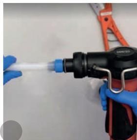
Una vez seleccionado el expandidor de la medida correspondiente a la tubería, este se insertará en el tubo manteniendo pulsado el gatillo de la máquina. Esta acción ensanchará el tubo + casquillo introduciendo el expansor hasta que alcance el tope. Finalizado ese proceso, suelte el gatillo y extraiga el expansor de la tubería.
