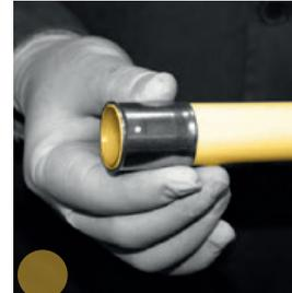
Insertar el casquillo de acero inoxidable en el tubo, en la posición que los orificios de inspección queden situados en el extremo del tubo.
