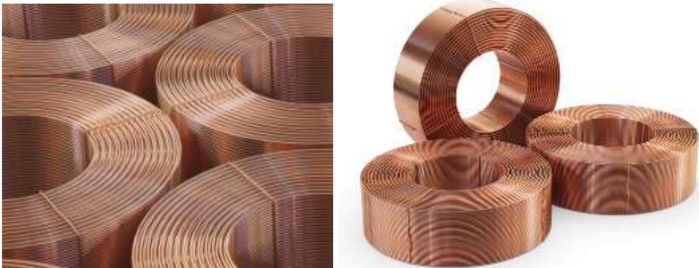
El tubo de cobre LWC (Cu - Dhp 99,99%) se utiliza principalmente en aire acondicionado, refrigeración y algunas aplicaciones generales de ingeniería. Los tubos de cobre LWC se fabrican de acuerdo con las normas EN 12735 y también cumplen con las normas ASTM B280.
