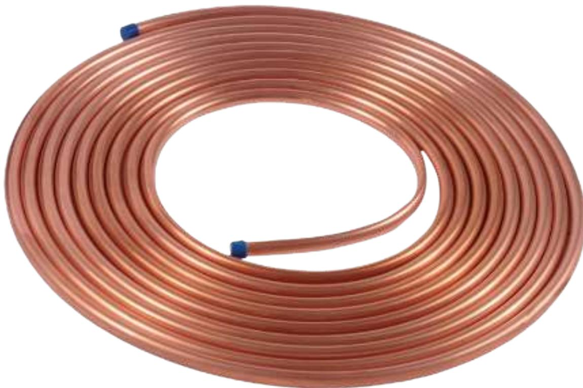
Rollos de Cobre (Cu - Dhp 99,9% R220 templado en bobinas, producido de acuerdo con la norma EN 12735-1, con alta resistencia a la corrosión, deshumidificado, con extremos limpios y cerrados, apto para uso en sistemas de aire acondicionado y refrigeración. Todos nuestros Rollos de Cobre están etiquetados con chorro de tinta y se suministran en una caja de cartón de fácil manejabilidad
