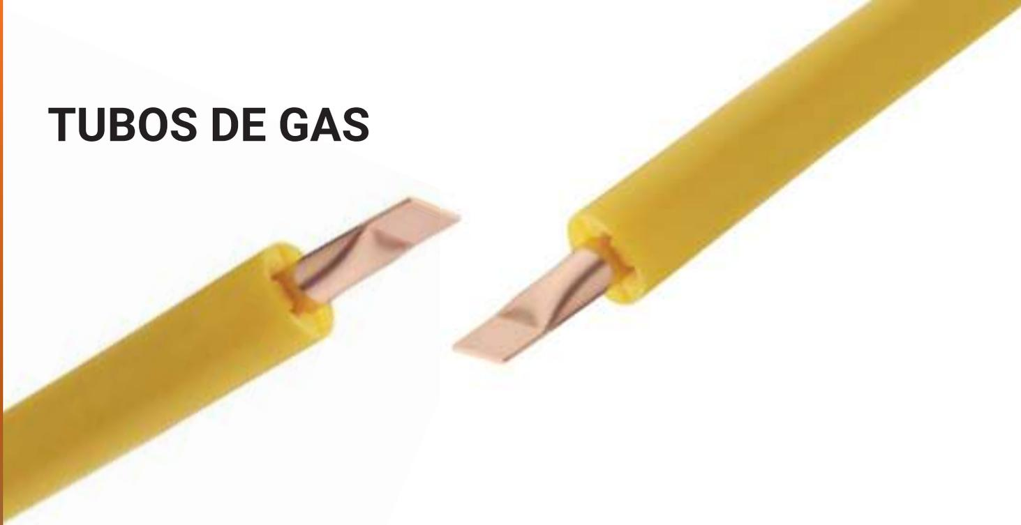
Los tubos de gas Ottocool de Cu DHP 99,9% Cobre - EN 1057 y ASTM B280 se fabrican recubiertas con aislamiento de polietileno expandido producido con maquinaria de última generación específicamente para la construcción de instalaciones de transporte de gas en residencias y de acuerdo con las disposiciones de UNI. CIG 7129.
