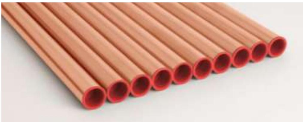
Los tubos de cobre en barras (Cu - Dhp 99,9%) se utilizan en sistemas de aire acondicionado y refrigeración e instalaciones sanitarias. Producidos como R220 tratado térmicamente y R290 duro, altamente resistentes a la corrosión de acuerdo con las normas EN 12735-1, los tubos de longitud de cobre se ofrecen con extremos cerrados y deshumidificados.
