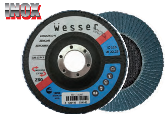
AZ Disco de zirconio para acero inoxidable, acero especial y plásticos. Superficie de contacto inclinada. Soporte de fibra. (color azul)
