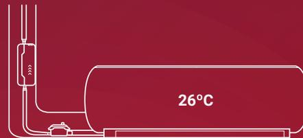
La **bomba de condensados** debe instalarse en un canal de una unidad de aire acondicionado con una **potencia de hasta 8 kW**
