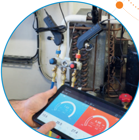
CONTROL CON MANIFOLD COMBINADO SI-RM13
