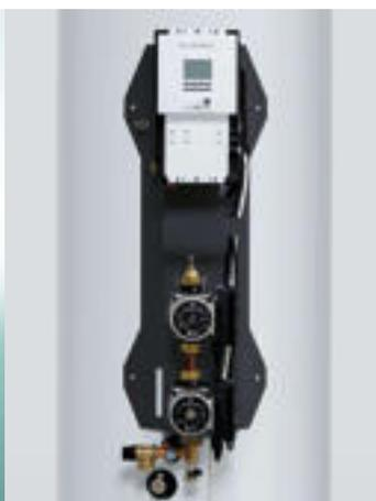
Producción solar de ACS tipo drenaje automático de carácter modular que permite al sistema ganar en flexibilidad. El depósito solar se puede combinar con un módulo solar que incluye todos los elementos necesarios: control, bomba y tuberías. Como accesorio está disponible la bomba auxiliar para llegar hasta 12 m de altura o la resistencia eléctrica de apoyo.
