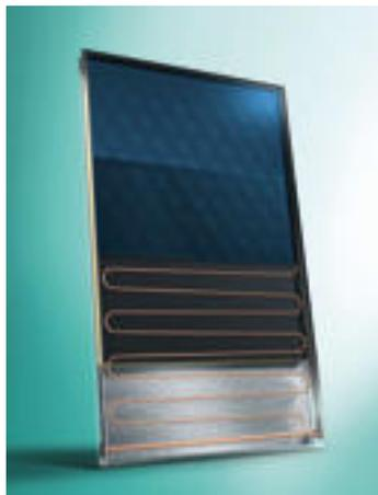
El captador VFK 135 VD está especialmente diseñado para funcionamiento en instalaciones de drenaje automático. Este sistema, al ser capaz de vaciar los captadores y la tubería de conexión por completo, elimina el riesgo de congelaciones en invierno y sobretemperaturas en verano.
