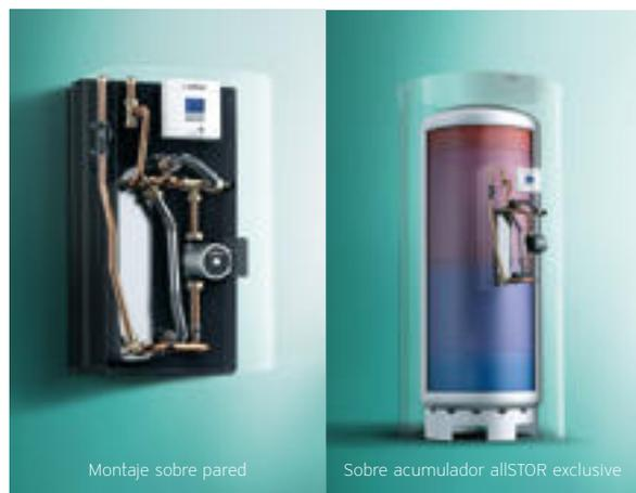
El módulo aguaFLOW exclusive genera el agua caliente en el grado justo de temperatura deseada. El agua potable pasa a través de un intercambiador de placas en el que se produce el calentamiento higiénico al paso. El agua caliente se genera cuando se demandan en el punto de extracción más de 2 l/min de agua caliente. El sensor de flujo que está integrado en la estación registra la velocidad de extracción.
