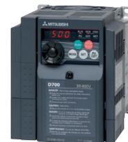
Diseñados para la regulación de velocidad por frecuencia en aplicaciones de ventilación. Ultracompacto, manejo muy sencillo y con amplio volumen de funciones. Panel con dial incorporado. PID. Filtro EMC opcional. Homologaciones: CE/UL/CSA/EN/GOST/CCC. Grado de protección: IP20.
